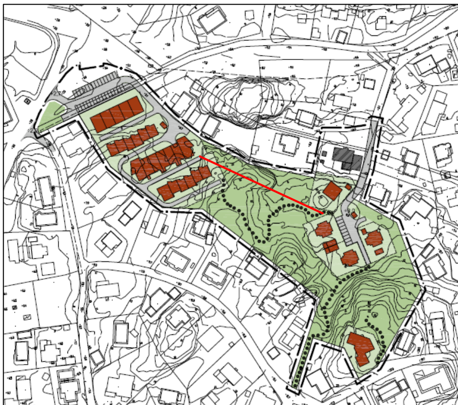
Figur 2. Utdrag från illustrationsritning över området. Ungefärlig placering av borrhål för dagvattenledning är inlagda med röd linje.
